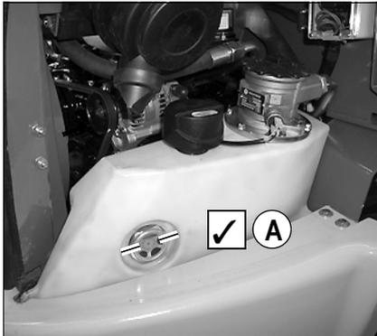
Abb. 176: Ölstandsauge am Hydrauliköltank
