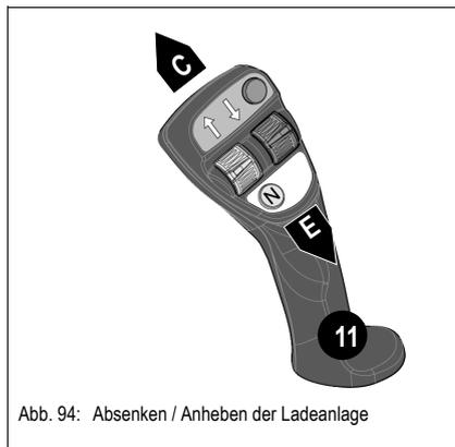
Abb. 94: Absenken / Anheben der Ladeanlage
