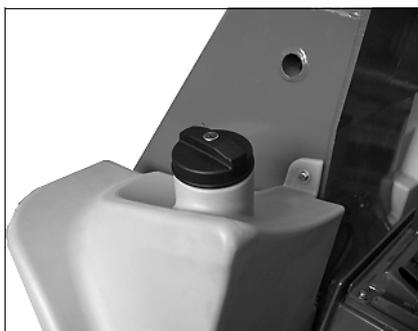
Abb. 162: Kraftstoff-Einfüllstutzen
