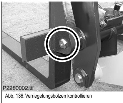
Die Aufnahme der Stapleinrichtung an die Schnellwechseleinrichtung erfolgt analog zur Ladeschaufel – *siehe Aufnahme Standardschaufel an die Schnellwechseleinrichtung* auf Seite 3-74.
