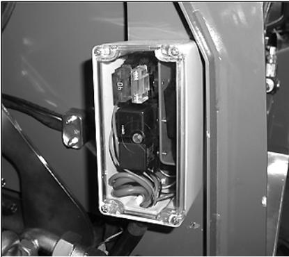
Abb. 190: Hauptsicherungskasten im Motorraum
