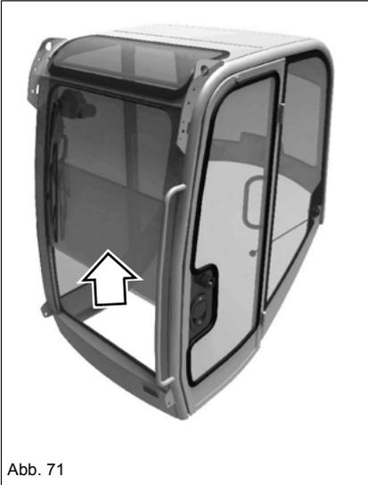
Die untere Frontscheibe **C** aus der Führung **D** herausheben und in den Führungen **E** hinter dem Fahrersitz ablegen.
