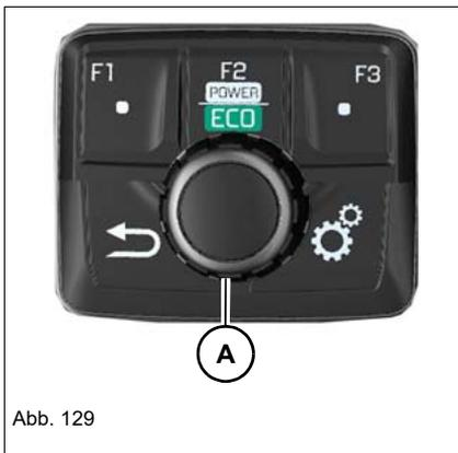
Die Drehzahl kann mit dem Steuerungsknopf **A** stufenlos geregelt werden – siehe Kapitel "Steuerungsknopf" auf Seite 4-27.
