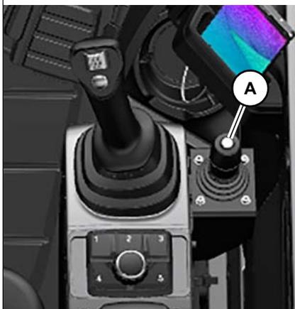
Abb. 133a Fahrstufenwahl 3TNV88F (Option schwenkbares Planierschild)
