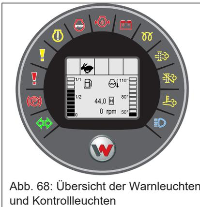
Abb. 68: Übersicht der Warnleuchten und Kontrollleuchten
