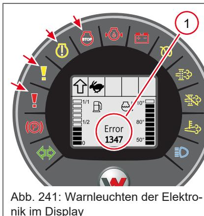
Abb. 241: Warnleuchten der Elektronik im Display
