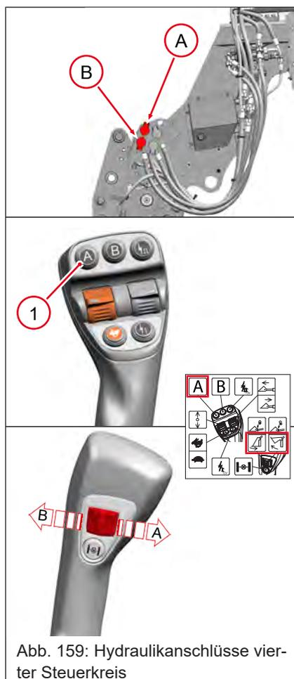
Mit dem vierten Steuerkreis können zusätzliche Hydraulikanschlüsse an der Ladeanlage bedient werden. Diese Hydraulikanschlüsse sind notwendig, wenn die serienmäßigen Hydraulikanschlüsse für bestimmte Anbauwerkzeuge nicht ausreichen.
