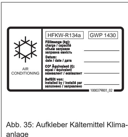
Abb. 35: Aufkleber Kältemittel Klimaanlage
