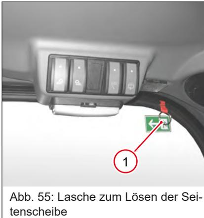
Abb. 55: Lasche zum Lösen der Seitenscheibe
