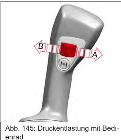
Abb. 145: Druckentlastung mit Bedienrad
