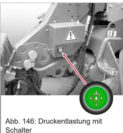
Abb. 146: Druckentlastung mit Schalter
