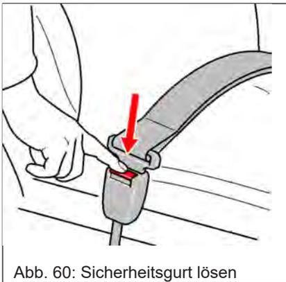
Abb. 60: Sicherheitsgurt lösen
