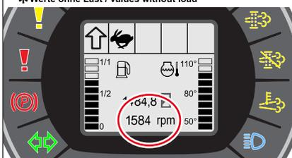
Abb. 154: Drehzahl der Zapfwelle
