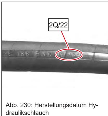
Abb. 230: Herstellungsdatum Hydraulikschlauch
