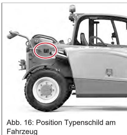
Abb. 16: Position Typenschild am Fahrzeug
