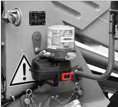
Abb. 212: Positionierung der Zentralschmieranlage am Fahrzeug
