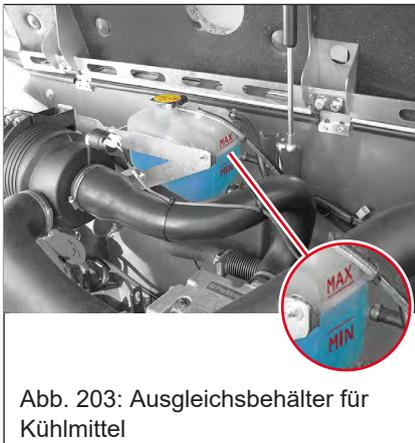
Abb. 203: Ausgleichsbehälter für Kühlmittel
