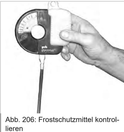
Das Frostschutzmittel verhindert ein Gefrieren des Kühlmittels bei Minusgraden und schützt den Motorblock und den Kühler vor innerer Korrosion. Unter normalen Bedingungen ist ein Frostschutzgehalt von -20 °C bis -30 °C ausreichend. Der Frostschutzgehalt kann mit Hilfe eines Frostschutzmessers festgestellt werden.
