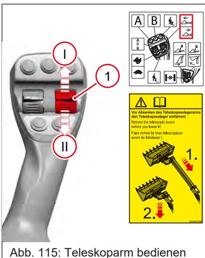
Abb. 115: Teleskoparm bedienen
