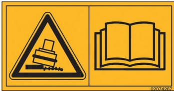
Geringe Bandagenbreite und hoher Schwerpunkt der Maschine erhöhen die Kippgefahr bei schneller Kurvenfahrt und beim Befahren von Querneigungen.
