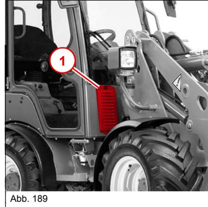
1. Deckel des Filtergehäuses 1 abschrauben.
