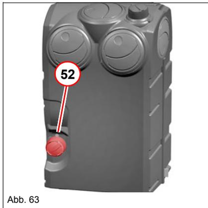
Die Fahrerkabine verfügt über eine Heizung mit Gebläse. Die Heizung wird mit dem Drehschalter **52** bedient.
