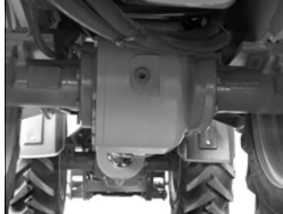
Achse mit Planetengetriebe 2\*
