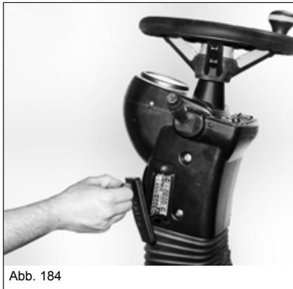
Die Stromkreise werden von verschiedenen starken Sicherungen geschützt. Diese Sicherungen befinden sich in dem Sicherungskasten an der linken Seite der Lenksäule.
