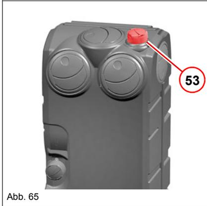
Die Fahrerkabine verfügt über eine Heizung mit Gebläse. Das Gebläse wird mit dem Drehschalter **53** bedient.
