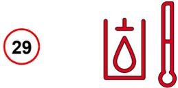
Leuchtet, wenn die maximal zulässige Hydrauliköltemperatur erreicht ist.
