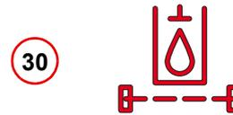
Leuchtet, wenn der Widerstand des Öldurchflusses im Rücklauffilter zu hoch wird.
