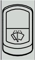
Der Kippschalter **49** befindet sich in der Kippschalterleiste 2, im Kabinendach rechts. Der Kippschalter **49** verfügt über zwei Schalterstellungen. Die erste Schalterstellung betätigt den Scheibenwischer an der Heckscheibe. Die zweite Schalterstellung betätigt die Scheibenwaschanlage an der Heckscheibe.
