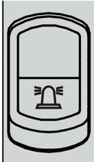
Der Kippschalter **45** befindet sich in der Kippschalterleiste 1. Der Kippschalter **45** schaltet die Rundumkennleuchte ein. Die Rundumkennleuchte nur gemäß den gesetzlichen Bestimmungen verwenden.
