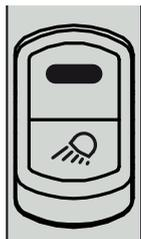
Der Kippschalter **43** befindet sich in der Kippschalterleiste 1. Der Kippschalter **43** verfügt über zwei Schalterstellungen. Die erste Schalterstellung betätigt die Arbeitsscheinwerfer vorn. Die zweite Schalterstellung betätigt den Arbeitsscheinwerfer hinten.
