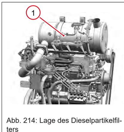
Abb. 214: Lage des Dieselpartikelfilters
