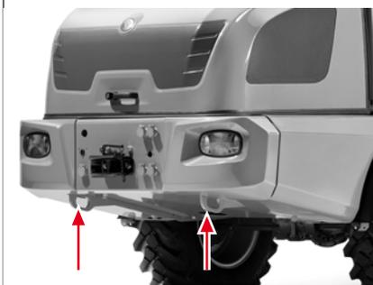
Abb. 173: Zurrösen am Fahrzeug
