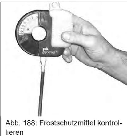
Abb. 188: Frostschutzmittel kontrollieren
