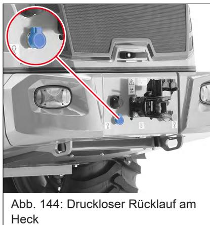
Abb. 144: Druckloser Rücklauf am Heck
