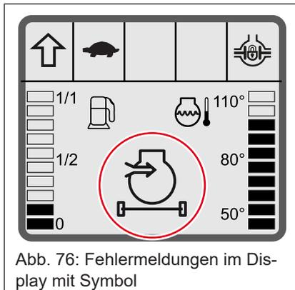
Abb. 76: Fehlermeldungen im Display mit Symbol
