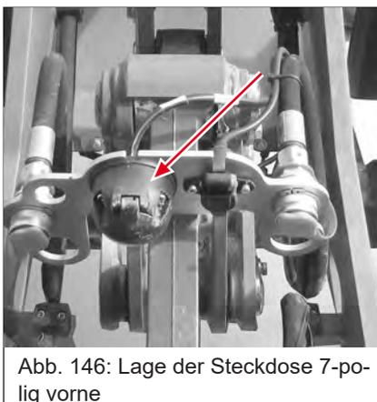
Die Steckdose 7-polig an der Ladeanlage dient zum Anschluss von Beleuchtungen an Anbauwerkzeugen, z. B. Schneeschild, Kehrbesen usw.
