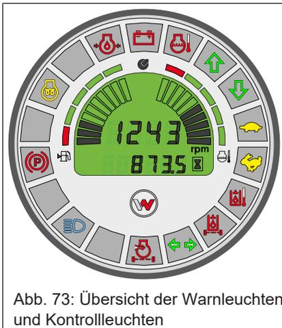
Abb. 73: Übersicht der Warnleuchten und Kontrollleuchten
