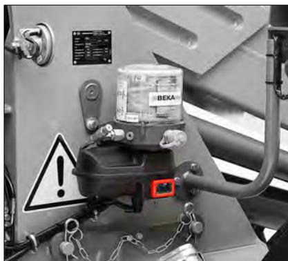
Abb. 193: Positionierung der Zentralschmieranlage am Fahrzeug
