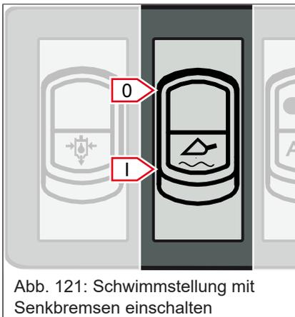
Abb. 121: Schwimmstellung mit Senkbremsen einschalten
