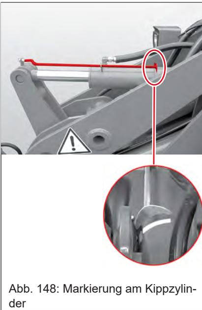
Abb. 148: Markierung am Kippzylinder
