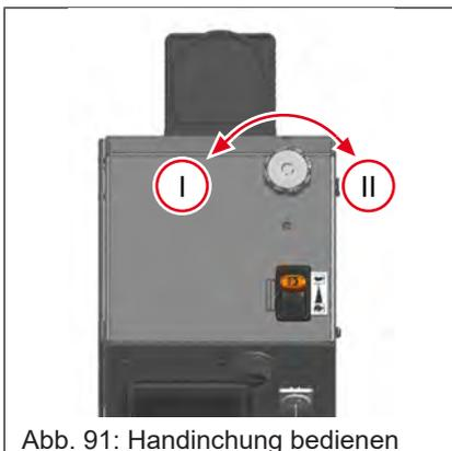
Die Funktion Handinching kann nur benutzt werden, wenn die Gangart Kriechgang gewählt ist. Mit der Funktion Handinching kann die Fahrgeschwindigkeit, unabhängig von der Drehzahl des Motors, individuell angepasst werden, ohne dass ständig das Brems-Inchpedal betätigt werden muss.
