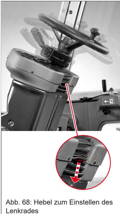
Abb. 68: Hebel zum Einstellen des Lenkrades
