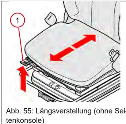
Abb. 55: Längsverstellung (ohne Seitenkonsole)
