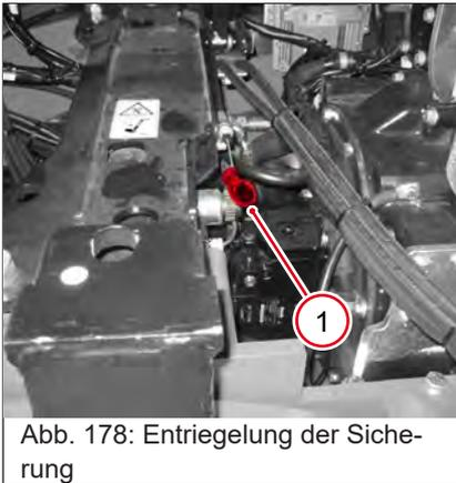
Abb. 178: Entriegelung der Sicherung
