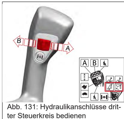
Abb. 131: Hydraulikanschlüsse dritter Steuerkreis bedienen
