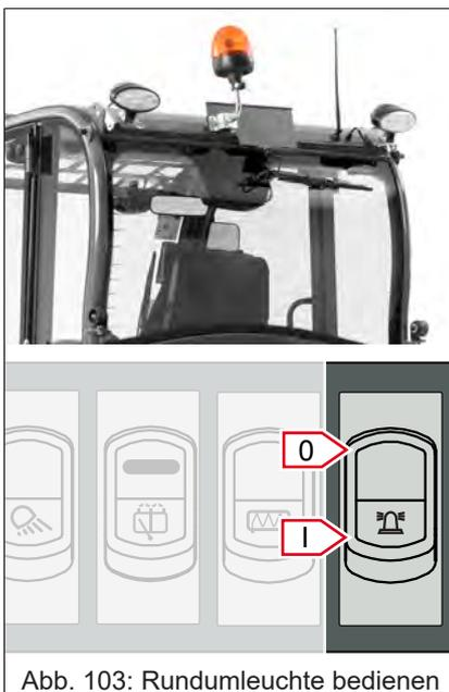
Abb. 103: Rundumleuchte bedienen
