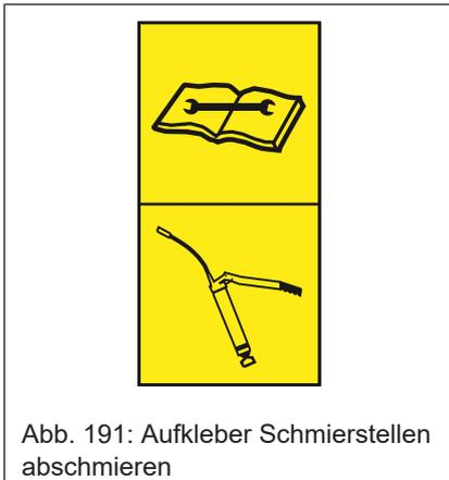
Abb. 191: Aufkleber Schmierstellen abschmieren
