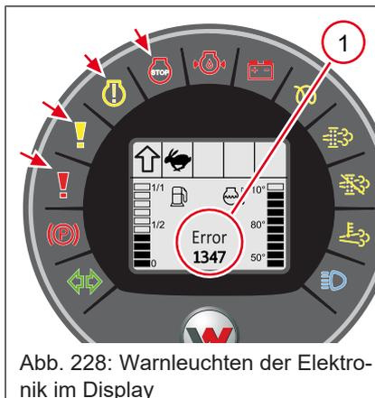
Abb. 228: Warnleuchten der Elektronik im Display
