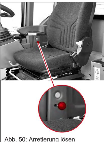
Abb. 50: Arretierung lösen
