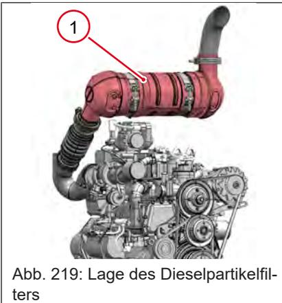
Abb. 219: Lage des Dieselpartikelfilters
