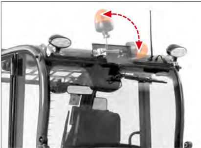
Abb. 104: Rundumleuchte umklappen
