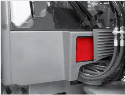
Abb. 199: KabinenbelüftungsfILTER
