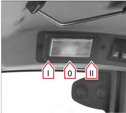
Abb. 107: Innenbeleuchtung bedienen
