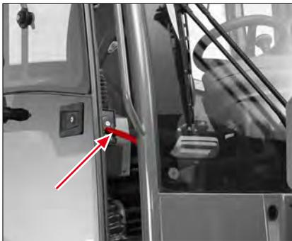
Abb. 51: Tür leicht geöffnet arretieren
