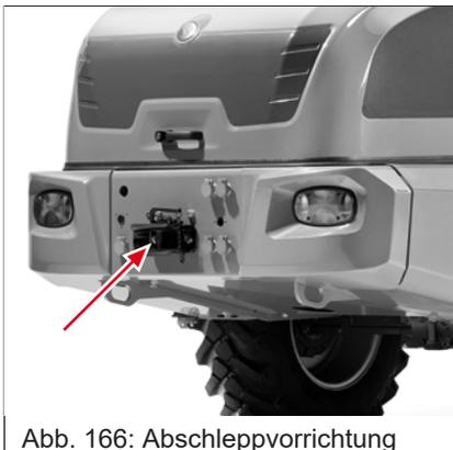
Abb. 166: Abschleppvorrichtung
