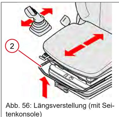
Abb. 56: Längsverstellung (mit Seitenkonsole)
