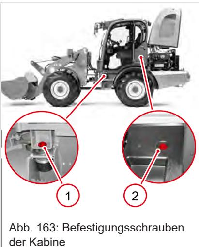
Abb. 163: Befestigungsschrauben der Kabine
