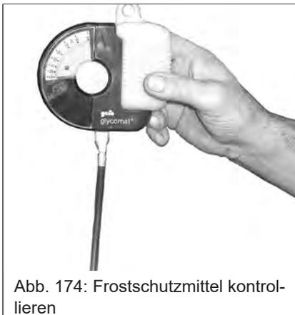
Abb. 174: Frostschutzmittel kontrollieren
