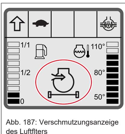
Abb. 187: Verschmutzungsanzeige des Luftfilters
