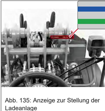
Abb. 135: Anzeige zur Stellung der Ladeanlage
