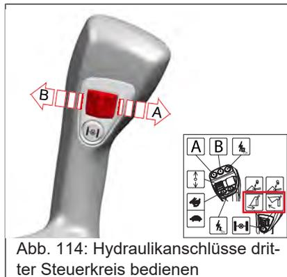
Abb. 114: Hydraulikanschlüsse dritter Steuerkreis bedienen
