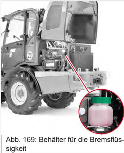
Abb. 169: Behälter für die Bremsflüssigkeit
