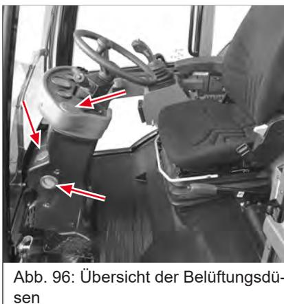
Abb. 96: Übersicht der Belüftungsdüsen
