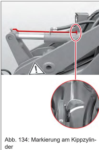
Abb. 134: Markierung am Kippzylinder
