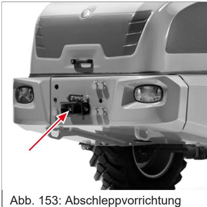
Abb. 153: Abschleppvorrichtung
