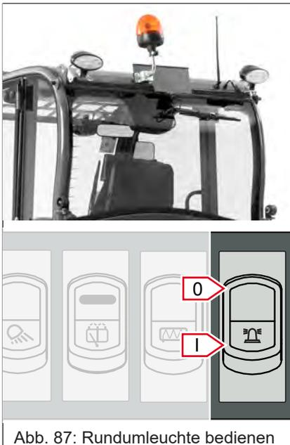
Abb. 87: Rundumleuchte bedienen
