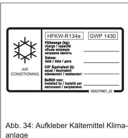
Abb. 34: Aufkleber Kältemittel Klimaanlage
