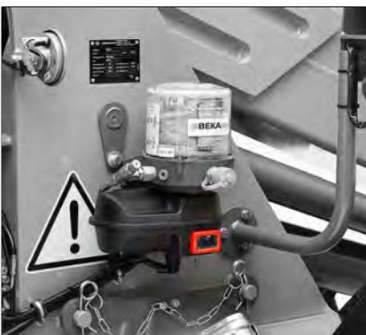
Abb. 179: Positionierung der Zentralschmieranlage am Fahrzeug
