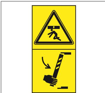
Abb. 19: Aufkleber Sicherheitsstütze
