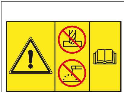
Abb. 25: Aufkleber ROPS/FOPS-Schutzaufbau
