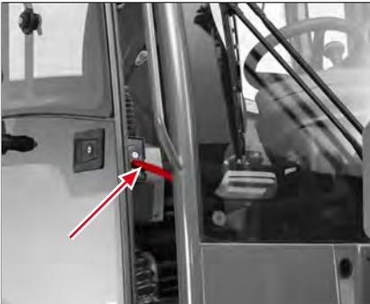
Abb. 49: Tür leicht geöffnet arretieren
