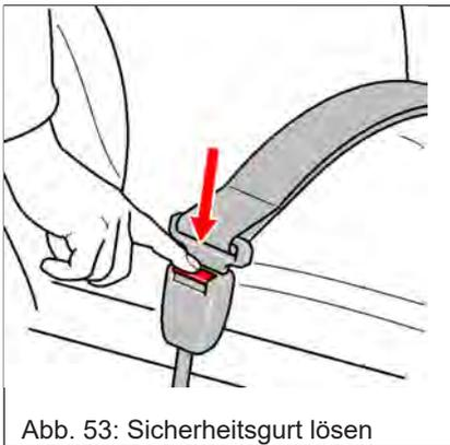
Abb. 53: Sicherheitsgurt lösen
