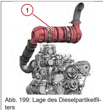
Abb. 199: Lage des Dieselpartikelfilters
