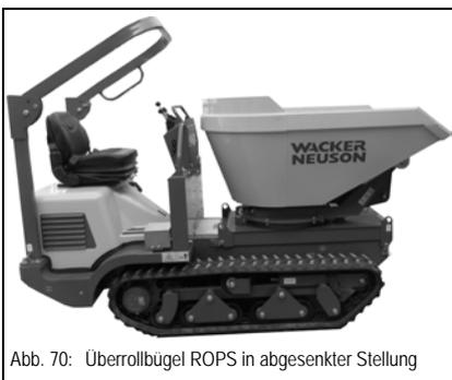
Abb. 70: Überrollbügel ROPS in abgesenkter Stellung
