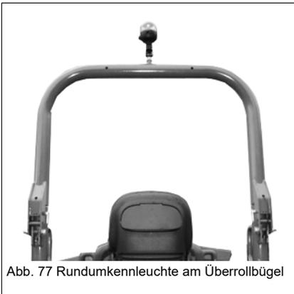
Abb. 77 Rundumkennleuchte am Überrollbügel
