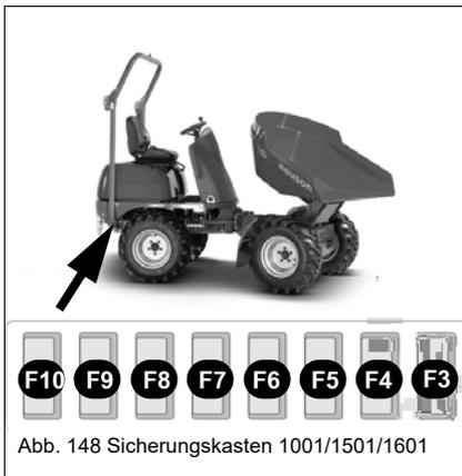
Abb. 148 Sicherungskasten 1001/1501/1601
