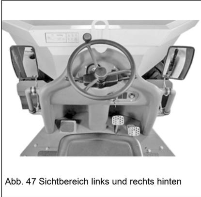
Abb. 47 Sichtbereich links und rechts hinten
