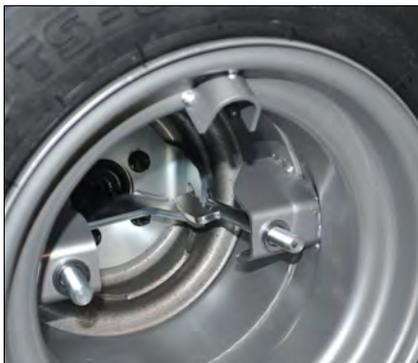
Abb. 143 Hakenschraube montieren
